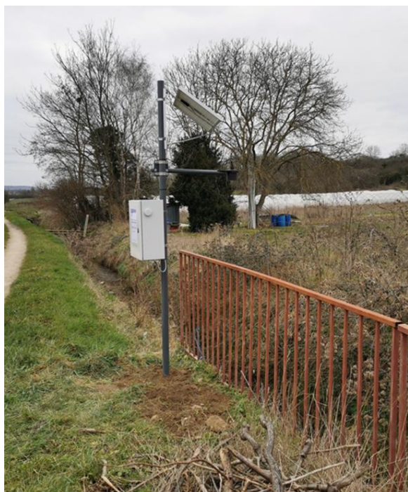
Figure 18 : Exemple de station alerte de crue installé par le prestataire Ogoxe
