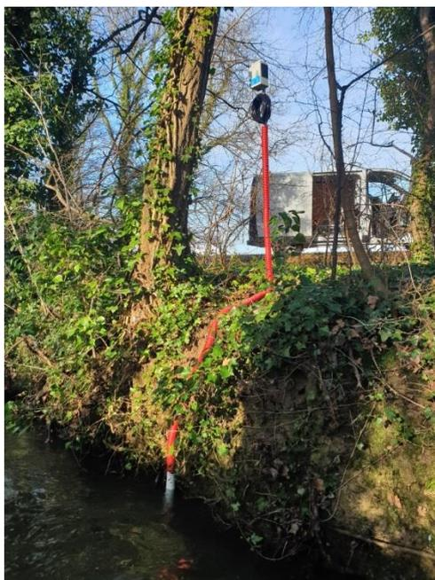
**Photo 48 : Station de mesure de hauteur d'eau**
