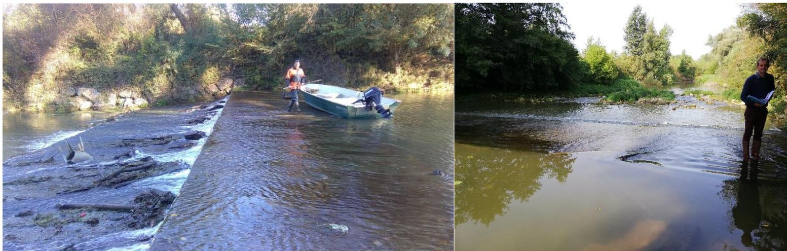
**Photos 18 et 19 : Mesures de tirant d'eau en amont de l'ouvrage de Casseuil**
