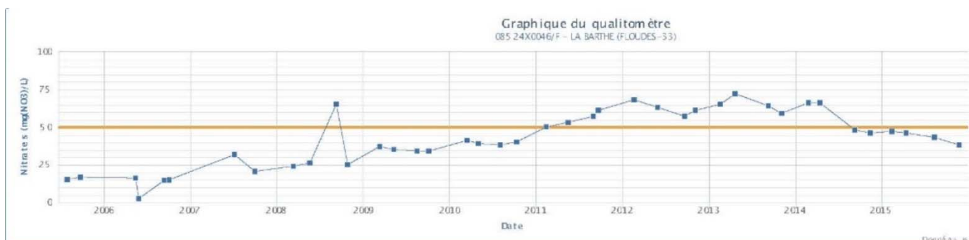
Figure 5 : Concentration en nitrate à la station 08524X0046/F- LA BARTHE à Floudes (33) – source ADES
